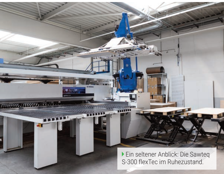
► Das effiziente Zusammenspiel von Lager und Säge funktioniert auch im Roboterbetrieb präzise und zuverlässig.
